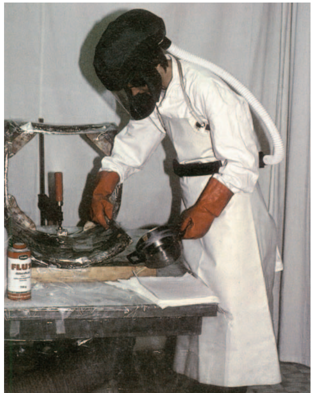
Abb. 1 Atemschutz während der Lackabnahme mit Atemhaube
