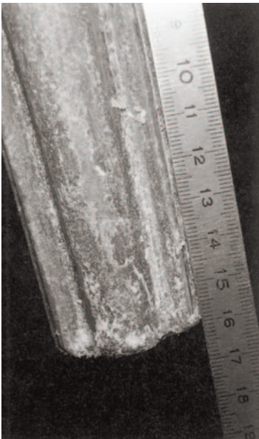
Abb. 4 Nach dreimaligem Auftrag des Abbeizfluids immer noch Lackreste, insbesondere in Profilvertiefungen
