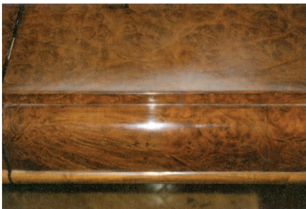
Abb. 3 Detail Tischplattenkante: milchige Trübung des duroplastischen Lackes
