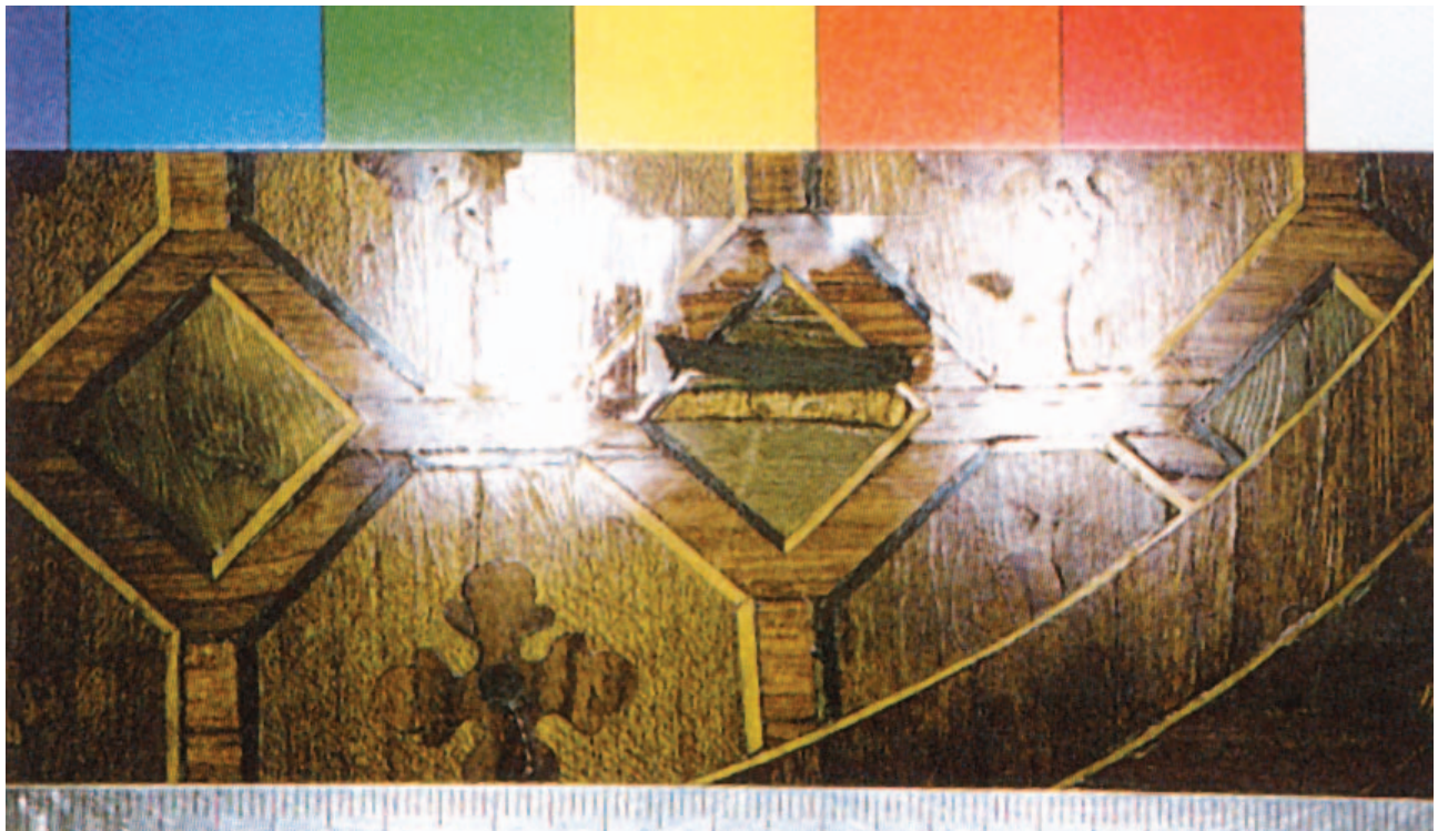
Abb. 3 Detail des Arbeitstisches von Abb. 1, Furnierrückseite. Farbkontrast von unbelichtetem Dunkelgrün zu ausgebleichetem Olivgrün der Furniervorderseite (Farbmusterkarte zur Kontrolle)
