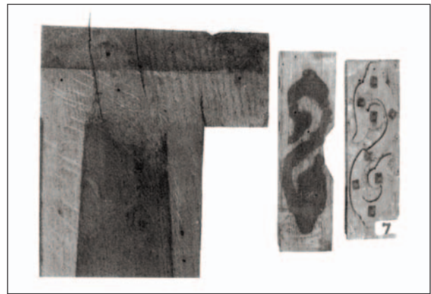
Abb. 5 Nicht abgebeizte Partien unter Ornament und Pilaster zeigen die durch eine Beize später rekonstruierte Altersfärbung des Eichenholzes
